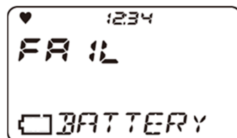
Panne de tension de la batterie
